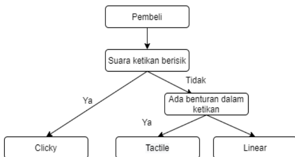
Gambar 4.1 Pohon Keputusan Pemilihan Tipe Switch dibuat melalui app.diagrams.net
